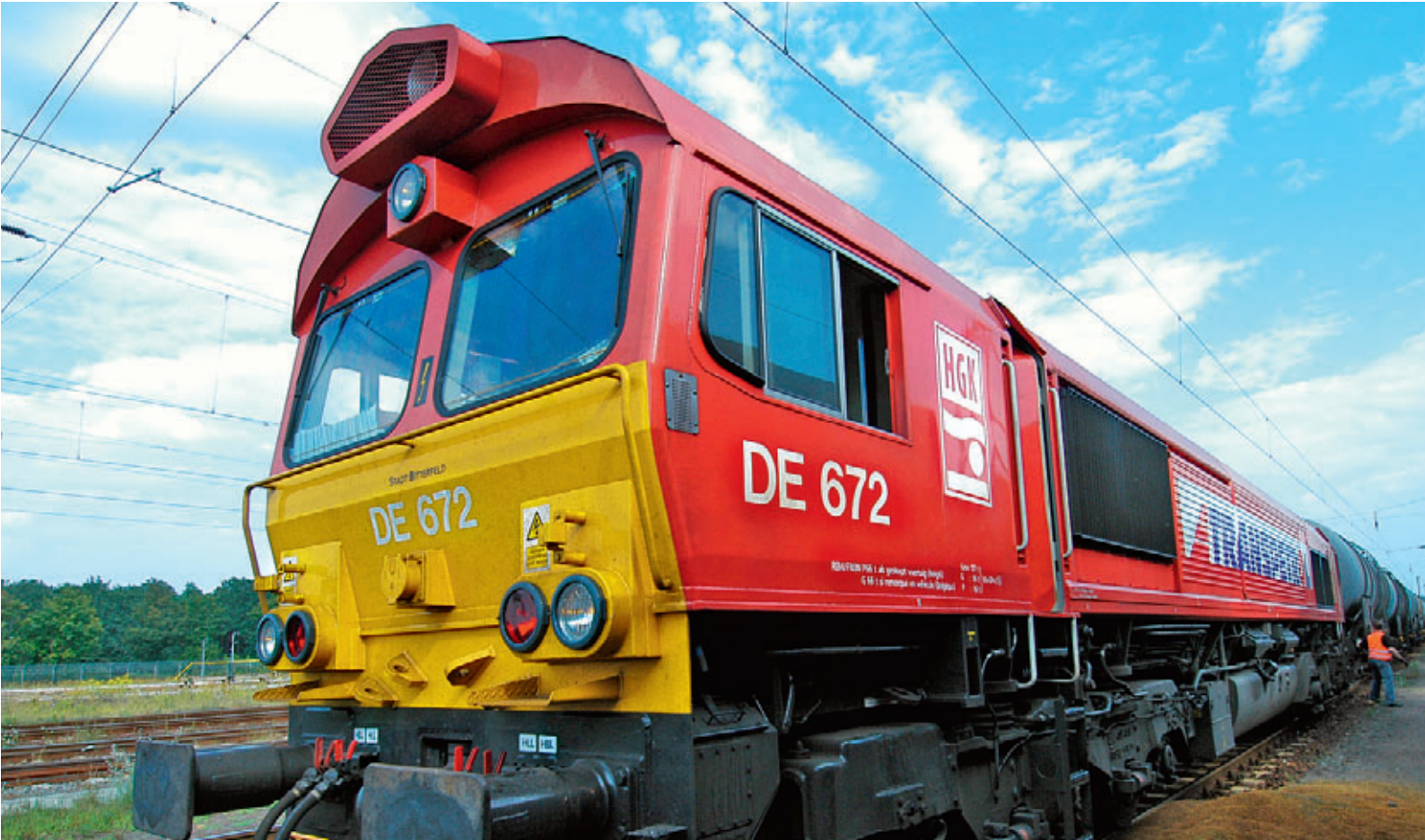
Abb. 2: Dieselelektrische Streckenlokomotive „Class 66“ der HGK (EMD JT 42 CWR, Leistung: 2420 kW) III. 2: “Class 66” diesel-electric mainline locomotive of HGK (EMD JT 42 CWR, capacity: 2.420 kW)
