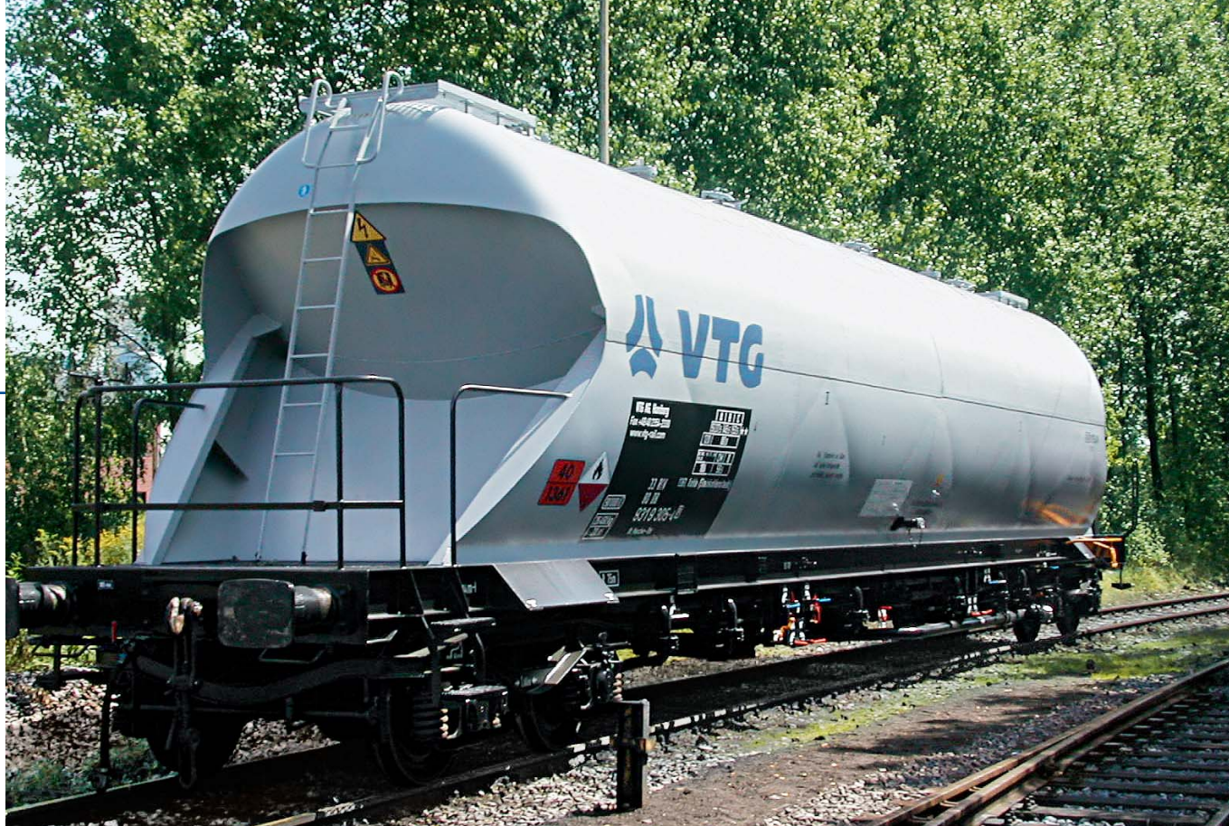
Der Filterstaub aus den Stahlwerken wird mit Staubgutwagen den Recyclinganlagen zugeführt. In den Anlagen wird der Zinkanteil herausgefiltert. The filter dust from the steel works is taken with powdery goods wagons to the recycling plants, where the zinc content is filtered out.
